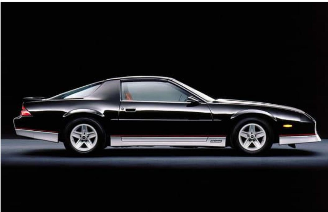
Da das IROC-Z eingezogen war, wurde der Z28 komplett ausgemustert. Die Basismodelle profitierten von der Umstellung, da sie die 15-Zoll-Räder erhielten, die zuvor beim Modell Z28 zu finden waren. Für die IROC-Zs wurde ein 1LE-Straßenrennsportpaket mit überdimensionalen Scheibenbremsen, einer Aluminium-Antriebswelle und einer abgestimmten Federung geliefert.
