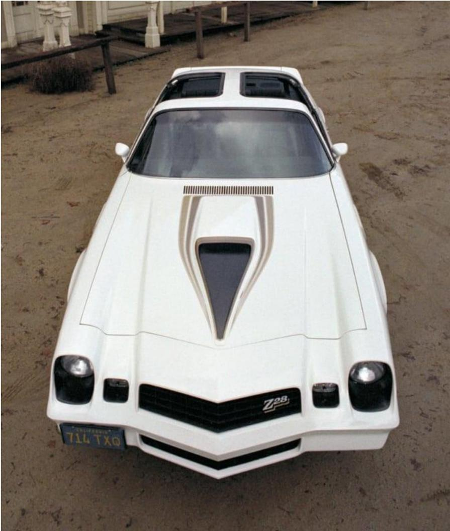
Das Auto bekam wieder neue Kunststoff-Stoßstangen vorne und hinten, diesmal in lackierten Farben, die zur Karosserie des Fahrzeugs passten. Eine überarbeitete Motorhaube mit Öffnung erschien zum ersten Mal, ebenso wie T-Tops nach dem Erfolg mit dem Trans-Am Modell. Der Camaro, der noch in den Modellen Standard, Typ LT, Rallye Sport und Z28 angeboten wird, hatte mit 272.631 Einheiten sein bisher meistverkauftes Jahr.
