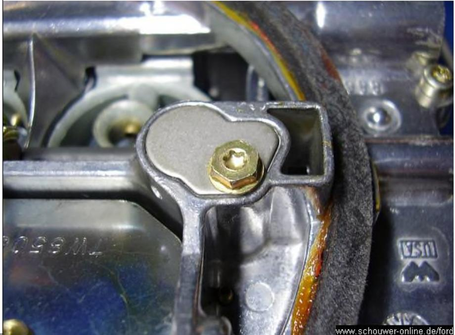
Die Deckel sind mit Torx-Schrauben gesichert. Diese werden mit einem passenden Schraubendreher oder Bit gerade so weit herausgeschraubt, dass man die Deckel beiseite schwenken kann.
