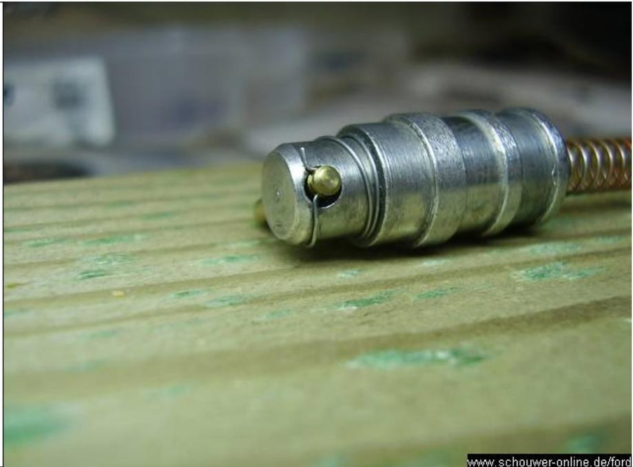
Nach dem Wiedereinsetzen der Nadel-Kolben-Federn-Kombination dreht man die Abdeckbleche (Bild 17) wieder in Position und schraubt die Torx-Schrauben mit geringem Drehmoment ("schraubendreherfest", ca. 1,5 Newtonmeter) an.
