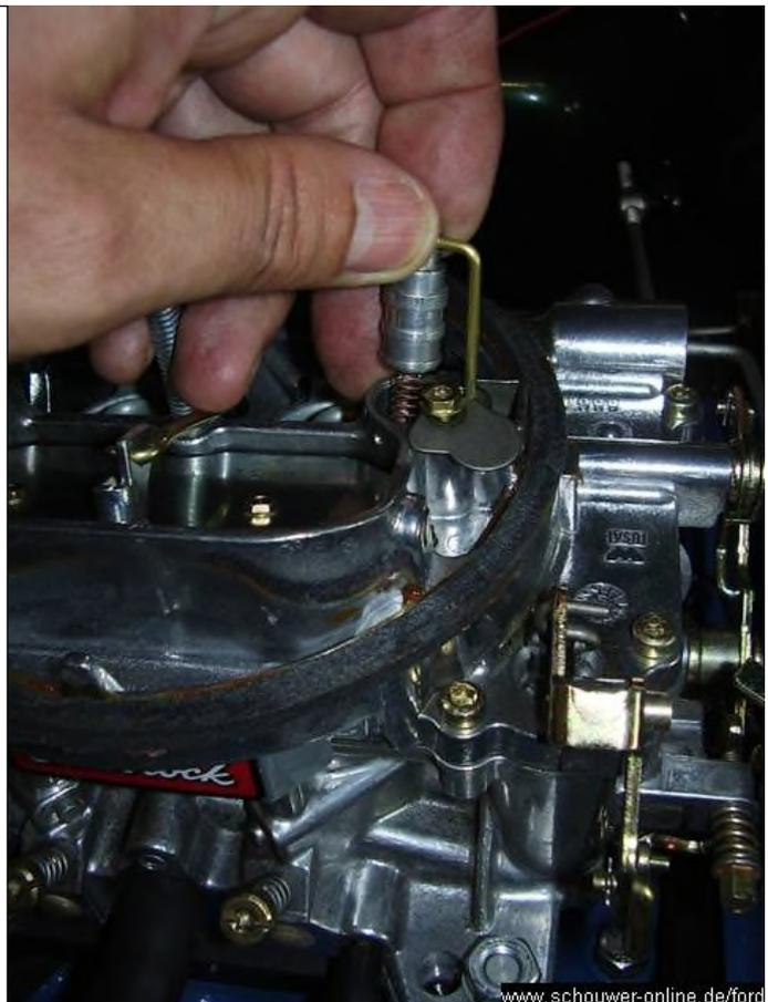
Man kann die Nadeln von den Unterdruckkolben trennen, indem man die Sicherungsfeder (Bild 20) nach unten drückt und die Nadel durch das Loch im Kolben herauszieht. Beim Einsetzen der neuen Nadel darauf achten, dass die Sicherungsfeder wie auf dem Bild 20 sitzt und gut in die Nut der Nadel eingreift.
